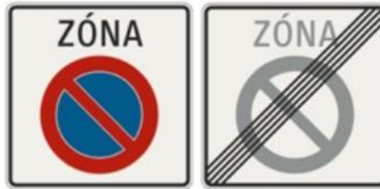
Obr. 4-1 Vzor zvislého dopravného značenia „Zóna zákazu státia“
