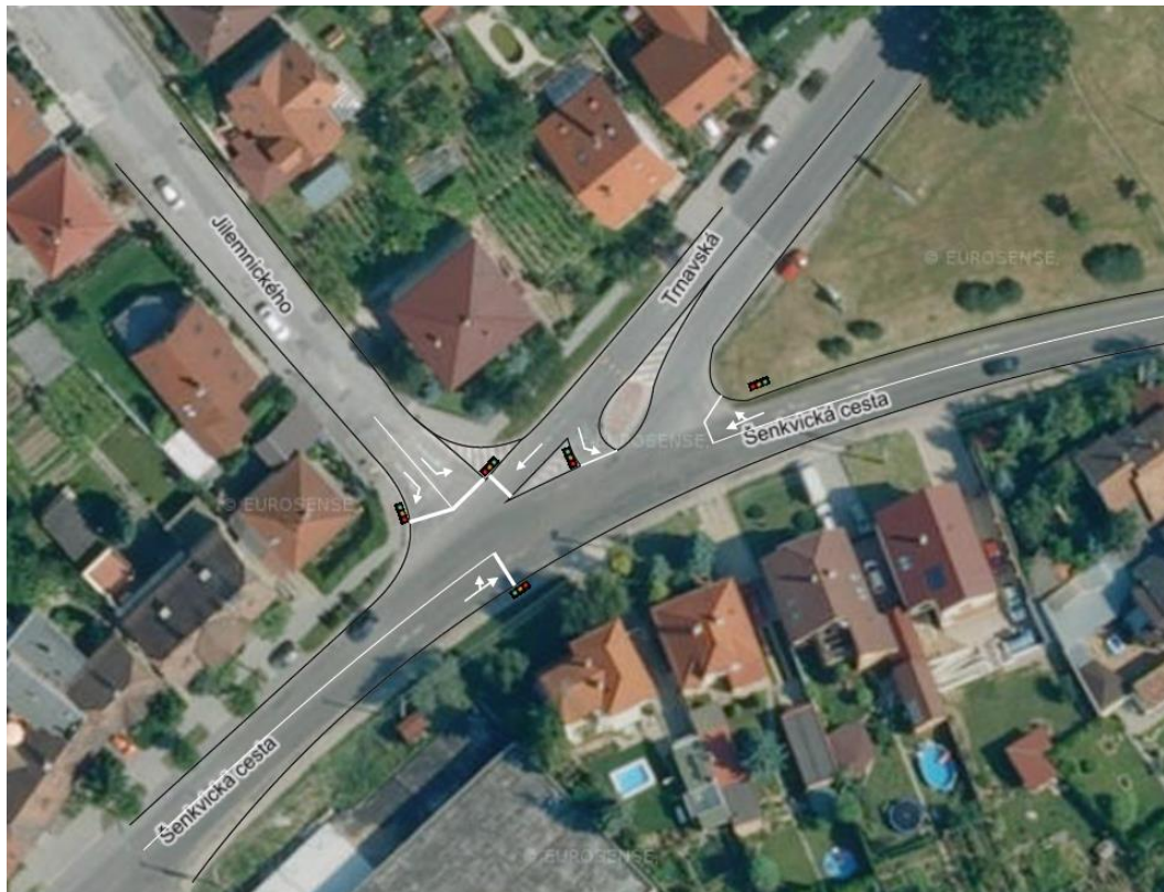
Obr. 4-6 Grafické znázornenie návrhu svetelne riadenej križovatky
