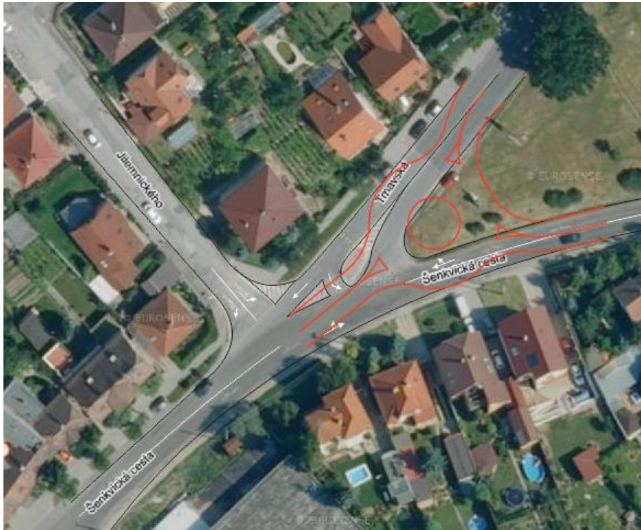
Obr. 4-5 Grafické znázornenie návrhu malej okružnej križovatky
